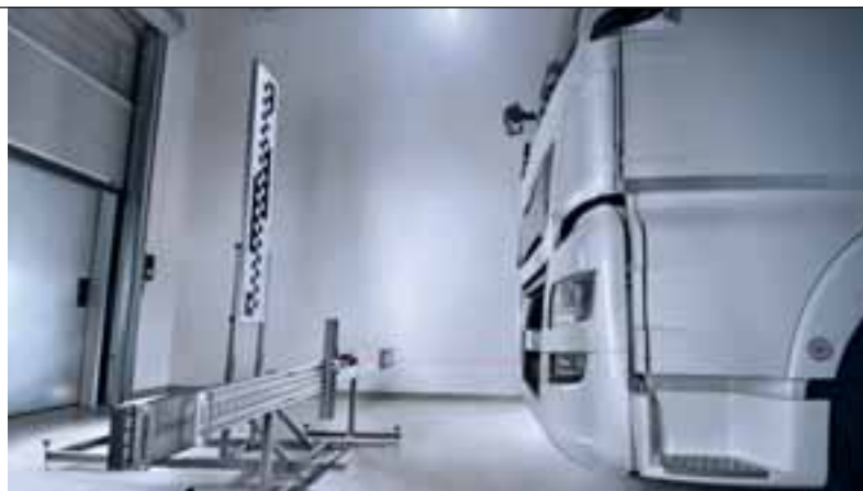
Gli strumenti di taratura e di controllo dei sistemi ADAS realizzati da Haweca su specifiche TEXA: si compongono di una traversa di misurazione, pannelli suddivisi per marca destinati alle telecamere e dispositivi laser con cui ristabilire il corretto allineamento e la taratura dei radar.
